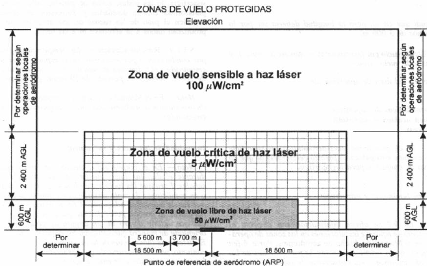
**Fig. 6-12 Zonas de vuelo protegidas indicando los niveles máximos de irradiación para rayos láser visibles**
